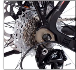
Die 3D-geschmiedeten Ausfallenden sind mit Edelstahl nach außen gegen die Spannnachse verstärkt. Die Trägerstrebe stützt sich von oben formschlüssig daran ab.
