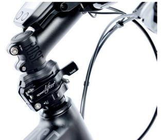
„Speedlifter twist“: stufenlose Höhenverstellbarkeit & Verdrehen des Lenkers.
