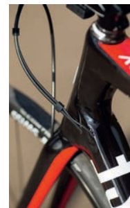
De remleiding loopt deels door de voorvork.
