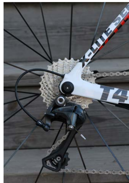
Snygg anslutning av vajern och infästningen av bakhjulet. Men avståndet mellan snabbkopplingen och bakväxeln är i underkant.
