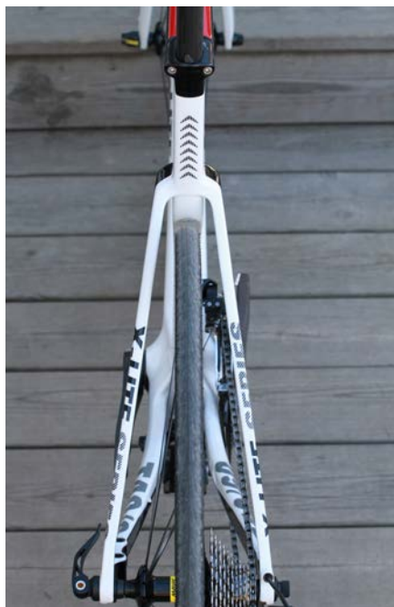
Mjuka och rena linjer i bakvagnen på nya Rose X-Lite, och fäste för skivbroms för den som önskar.
