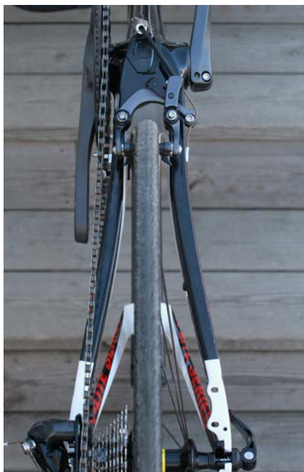
Mjuka och rena linjer i bakvagnen på nya Rose X-Lite, och fäste för skivbroms för den som önskar.
