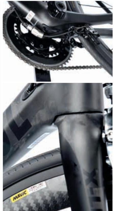
**Oben: Aus aerodynamischen Gründen ist die hintere Bremse unter dem Tretlager montiert. Unten: Fließender Übergang zwischen Gabel und Rahmen.**
