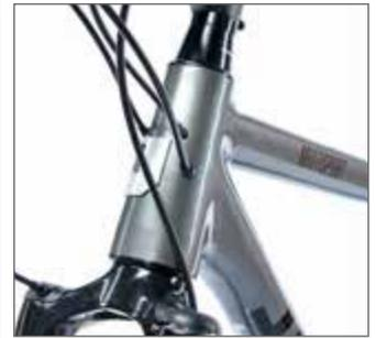
Das konische Steuerrohr fungiert auch als ordnendes Element für die Schalt- und Bremszüge.
