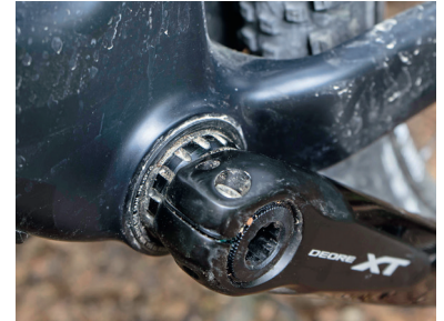
Oben: Durch das Zweifach-Setup mit 11–42er-Kassette ist man beim Rose etwas breiter aufgestellt. Unten: Das BSA-Innenlager sitzt in einem BB30-Adapter. Ein Teil mehr, das knacken kann, aber man kann Kurbeln mit 30er-Welle nachrüsten.
