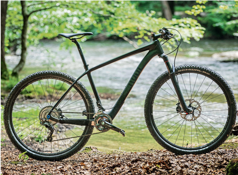
Oben: Durch das Zweifach-Setup mit 11–42er-Kassette ist man beim Rose etwas breiter aufgestellt. Unten: Das BSA-Innenlager sitzt in einem BB30-Adapter. Ein Teil mehr, das knacken kann, aber man kann Kurbeln mit 30er-Welle nachrüsten.
