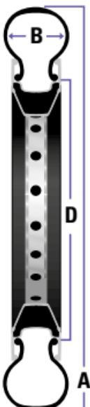
**ETRTO:** De door de 'European Tire and Rim Technical Organisation' gehanteerde norm luidt: breedte dwarsdoorsnede **B** en velgdiameter op de plek waar de band op de velg klemt **D** in millimeters.
