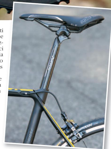
della scatola, in caso anche di presenza di un gruppo elettromeccanico (per il quale il telaio è perfettamente compatibile), grazie alla placca in plastica removibile. A completare il quadro anche il collarino reggisella semintegrale rispetto alla linea del telaio.
