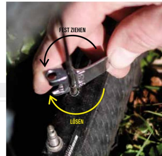
Notfallzentrierung: Ergebnis nach jeder Vierteldrehung überprüfen!
