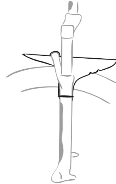
Die Kabelbinder für einen optimalen Halt rechtwinklig anbringen und überstehende Enden einkürzen.
