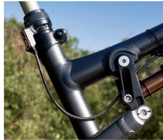
Molto bella l'anodizzazione nera del telaio, che dona un'aria di eleganza minimale alla Root Miller 8. Qui in evidenza, la biella in due pezzi che aziona l'ammortizzatore
