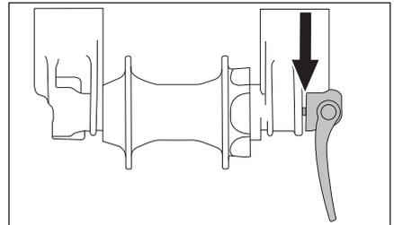
7. Schließe den Hebel der Steckachse.
