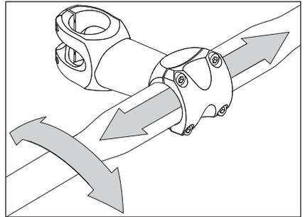
4. Ziehe die Schrauben der Lenkerklemmung abwechselnd in kleinen Schritten an, bis das Anzugsdrehmoment erreicht ist. Du findest das nötige Anzugsdrehmoment auf dem Vorbau oder im Kapitel „8,5 Anzugsdrehmomente“ auf Seite 38.
