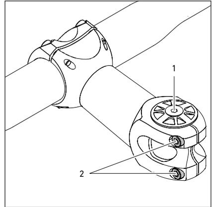
3. Prüfe das Steuersatzspiel, indem du die Vorderradbremse ziehst und das Fahrrad langsam vor und zurück bewegst.
