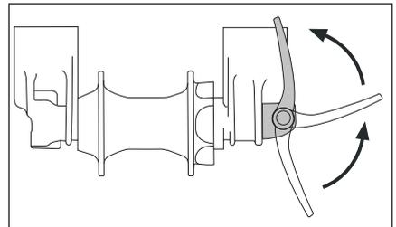
Der Hebel der Steckachse kann so eingestellt werden, dass er an einem beliebigen Punkt entlang der Achse schließt, sodass er nicht den Rahmen berührt und keine Komponenten stört. Beachte hierzu die Bedienungsanleitung deiner Rock Shox Maxle Ultimate Steckachse.
