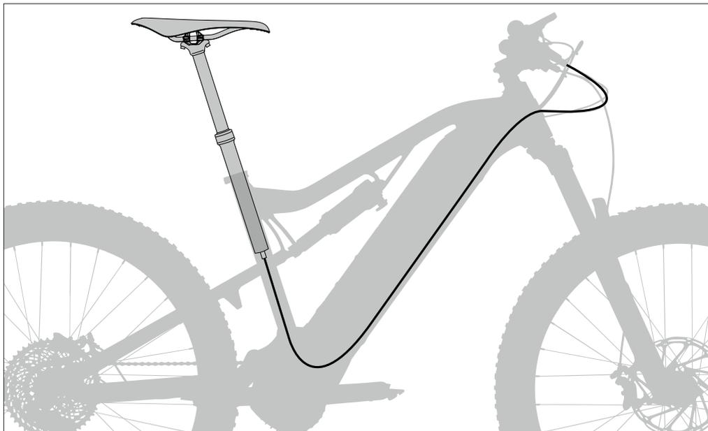
Die Leitung der Vario-Sattelstütze wird beim Modell „Elec Tec FS“ komplett im Rahmen geführt und tritt erst am Steuerrohr aus dem Rahmen aus.
