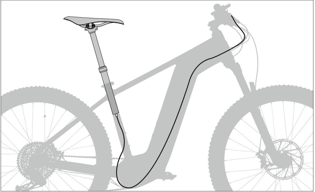
Die Leitung der Vario-Sattelstütze tritt beim Modell „Elec Tec“ am unteren Ende des Sattelrohrs aus dem Rahmen aus und unterhalb des Antriebs wieder in den Rahmen ein. Von dort wird die Leitung im Rahmen geführt, bis sie im Steuerrohrbereich wieder austritt.
