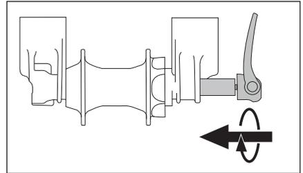
6. Drehe die Steckachse so weit in das Gewinde im Ausfallende, dass zwischen Steckachse und Ausfallende nur noch ein kleiner Spalt zu sehen ist.
