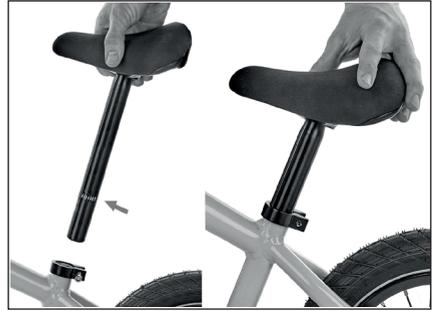
3. Schrauben der Sattelklemmschelle mit einem Drehmoment von 5 Nm anziehen.
