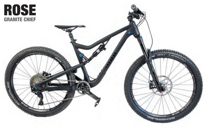
dalla scelta di battute Boost che consentono la costruzione di ruote superiori da questo punto di vista, mentre la scatola del movimento centrale è, come da tradizione con i telai in alluminio, per calotte esterne filettate, così come troviamo nella tubazione di sterzo quelle inserite invece per interferenza (cioè semi-integrate).
