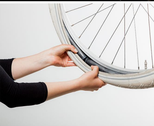
Schritt 11 von 14: Beide Enden des GAADI Schlauchs müssen nach dem Einlegen gegenüber liegen.
