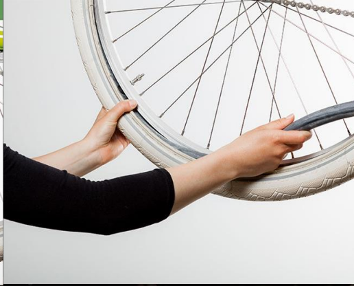
Schritt 10 von 14: Die lange Seite des GAADI Fahrradschlauchs einlegen.
