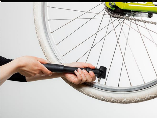
Schritt 14 von 14: Den Reifen aufpumpen und abschließend überprüfen, ob der Mantel sauber auf der Felge sitzt.
