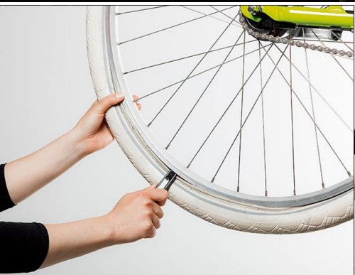
Schritt 13 von 14: Für das letzte Stück des Mantels am besten den Reifenheber wieder verwenden.
