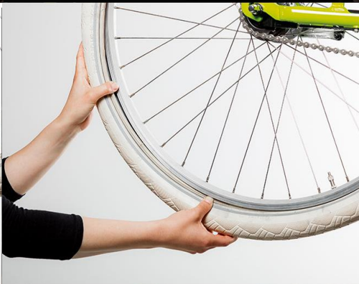
Schritt 12 von 14: Offene Mantelseite wieder in die Felge einsetzen.
