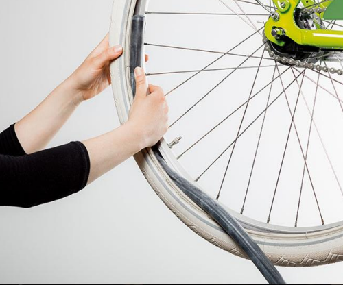
Schritt 9 von 14: Den GAADI-Schlauch mit der kurzen Seite zuerst einlegen.
