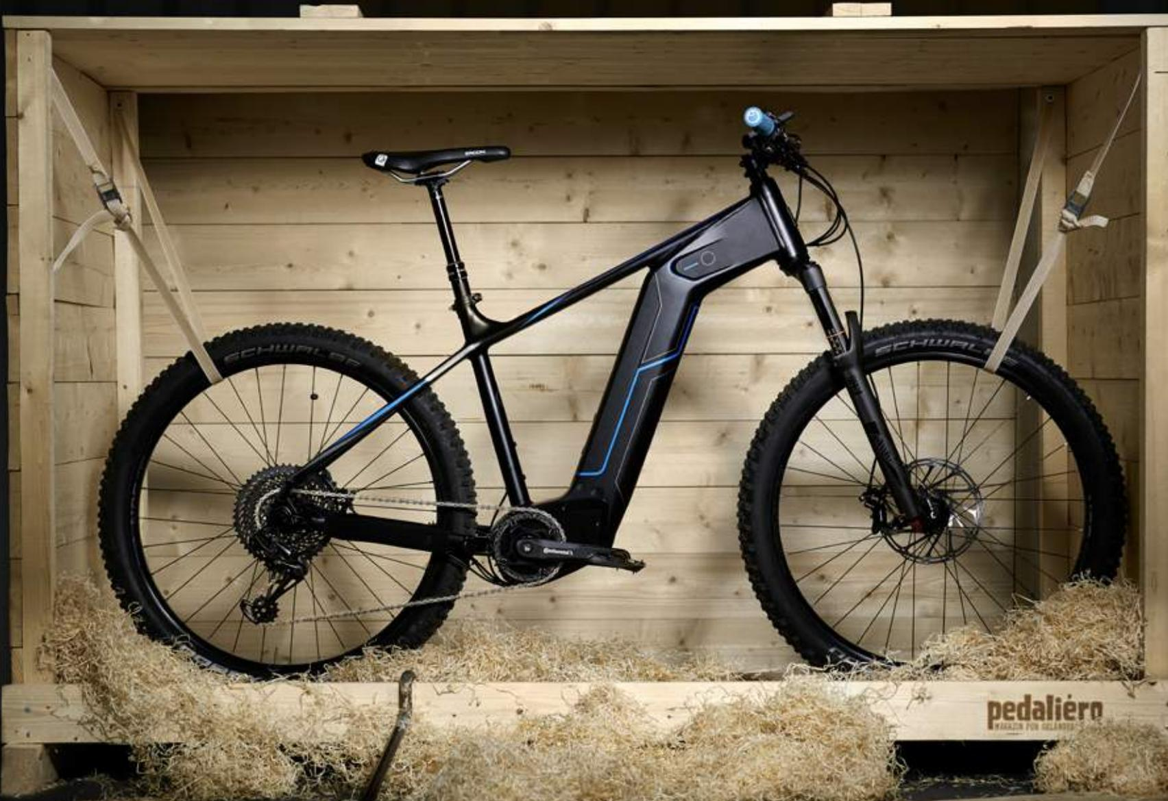
**AKKU UND MOTOR DEZENT IM RAHMEN VERSTECKT, POTENTE 120 MILLIMETER FEDERWEG AN DER FRONT, BRACHIALES RAHMENDESIGN – SO SIEHT DAS ERSTE E-MTB VON ROSE AUS! DAS ELEC TEC IST ALS TRAIL-HARDTAIL AUSGELEGT, EIN FLINKER WEGGEFÄHRTE MIT ORDENTLICH SCHUB UNTER DER HAUBE. ES IST KOMPATIBEL MIT 29- UND 27,5-ZOLL-LAUFRÄDERN, WAS DEM EINSATZBEREICH DES BOLIDEN ZUGUTE KOMMEN SOLL.**
