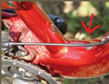
Le Rose est équipé d'un dérailleur avant Shimano type Side Swing dont le passage "direct" du câble limite les frictions.
