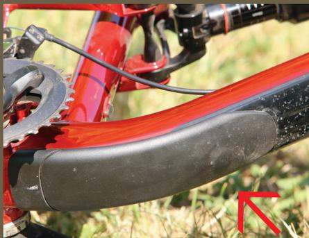
Bien vu, la large protection en plastique placée sous le tube diagonal. C'est assez rare sur un cadre alu.
