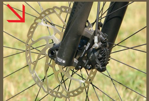
Doté d'un disque avant en 203 mm, les freins Shimano SLX se sont révélés puissants et faciles à doser. Le top !
